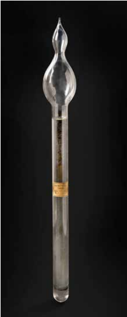
92 Marteau d'eau en verre pour expériences sur la chute des solides L. 40 cm
