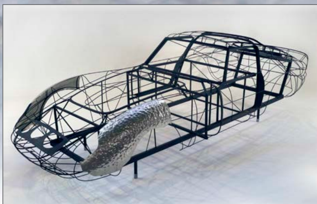
Gabarit issu des Ateliers Scaglietti, construit pour contrôler les éléments de carrosserie en aluminium de la Ferrari 250 GTO
